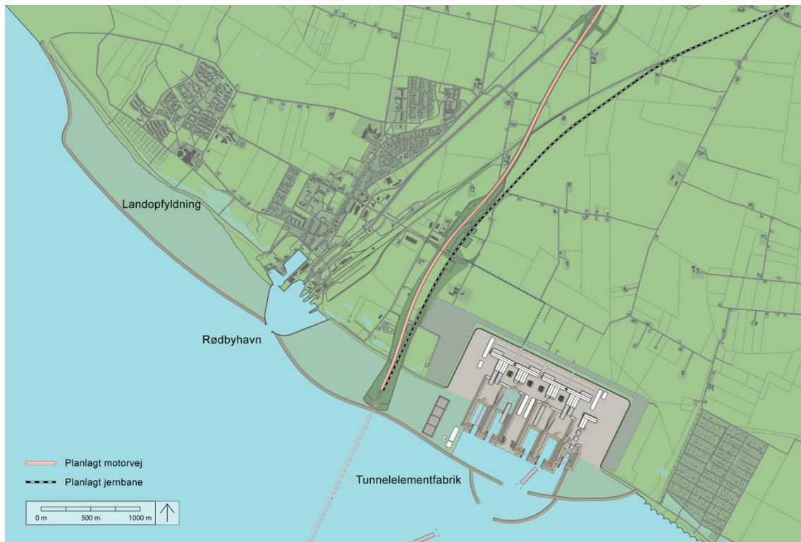
Figur 8. Principskitse for produktionsanlæg for tunnelelementer
