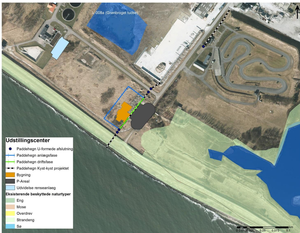
Figur 3: Placering af paddehegn omkring udstillingscenter og p-plads. Paddehegn er vist med hhv. blå og grøn linje. De grønne linjer angiver paddehegn, der vil stå der i driftsfasen. De blå linjer angiver paddehegn, der kun er opstillet i anlægsfasen.
