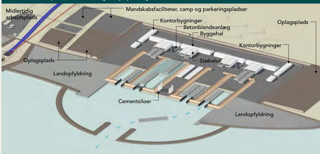
FIGUR 7.6 Principskitse af midlertidig arbejdsplads og cut-and-cover-tunnelen – Lolland
