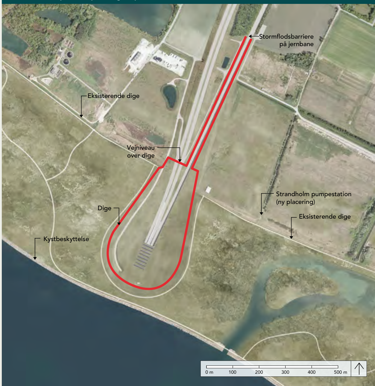
FIGUR 5.3 Principkitse af portal- og rampeområdets hovedelementer – Lolland
